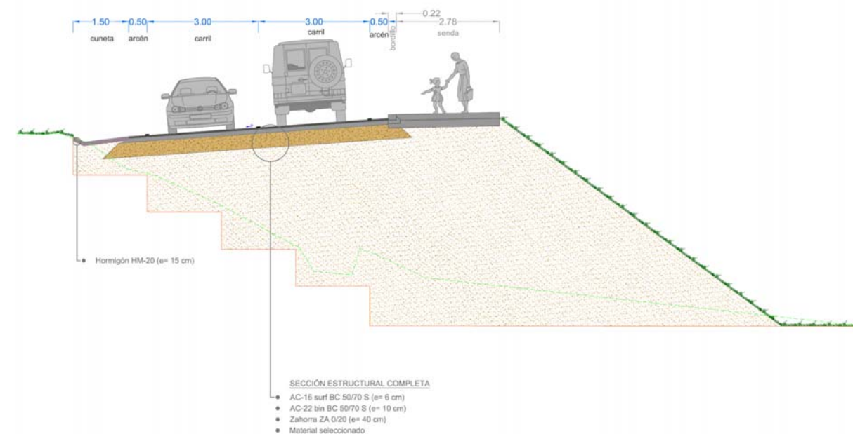
Sección tipo de la mejora de trazado del tronco de la AC-301
